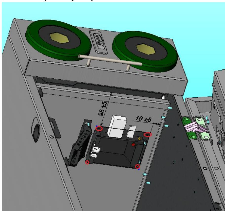
После разметки необходимо просверлить 4 отверстия диаметром 4,5 мм, затем закрепить с помощью Винтов М4х12 DIN 965 — 4 шт. и Гаек М4 DIN 6923 — 4шт. комплект регистратора.
