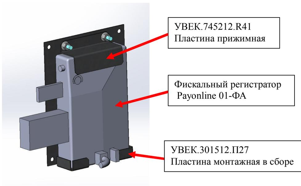
2) Установить кронштейн с фискальным регистратором в тумбу. Используя в качестве шаблона комплект крепления фискального регистратора разметить 4 места для отверстий по следующим размерам:
