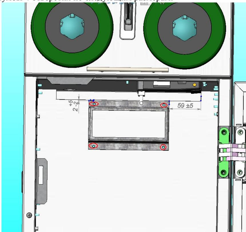
После разметки необходимо просверлить 4 отверстия диаметром 4,5 мм, затем закрепить с помощью Винтов М4х10 DIN 7985 - 4 шт., Шайб А4,3 DIN 125 - 4 шт., Шайб А4,1 DIN 127 - 4 шт. и Гаек М4 DIN 6923 — 4шт. комплект БП.
