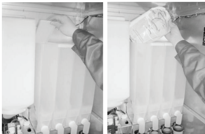
Рисунок 15 - Заполнение контейнеров для растворимых ингредиентов
