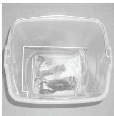
Рисунок 3 - Контейнер для жидких отходов, закреплённый пластиковыми стяжками
