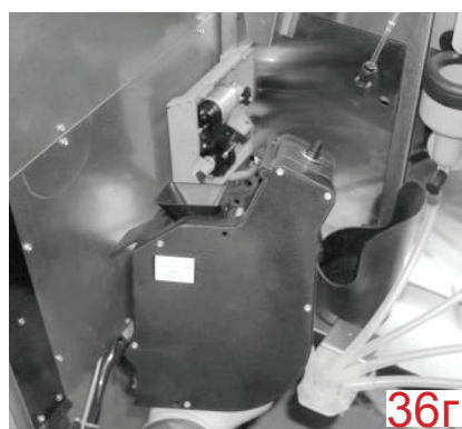
Рисунок 36 - Демонтаж группы эспрессо
