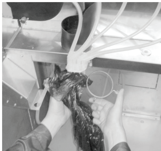
Рисунок 25 - Обжим мешка для сбора твёрдых отходов
